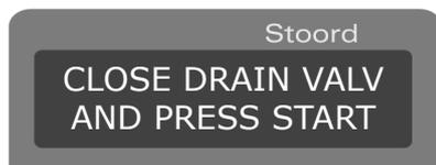
Debe verificar que la válvula de drenaje este cerrada y luego presionar la tecla START.
