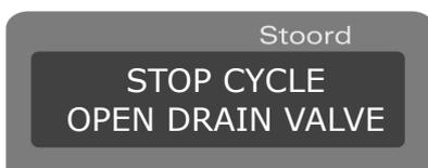
Una vez presionado STOP verá el cartel de la izquierda y sonará una alarma. Debe abrir la válvula de Drenaje y esperar.
