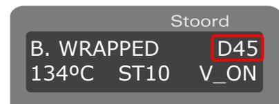
Presione una vez mas PROG para dejar guardado el nuevo valor y pasará a titilar el parámetro correspondiente al estado de la bomba de vacío (ON / OFF).
